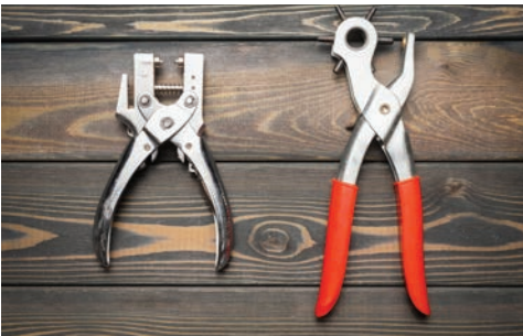
Мал. 15.12. Інструменти та пристосування для заклепкових з'єднань
