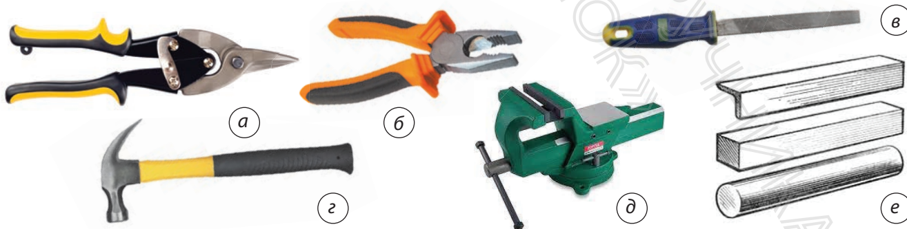
Мал. 15.3. Інструменти та пристосування, необхідні для виготовлення виробів із тонколистового металу : а — ножиці по металу; б — плоскогубці; в — напилек із мілкою насічкою; г — молоток; д — слюсарні лещата; е — оправка
