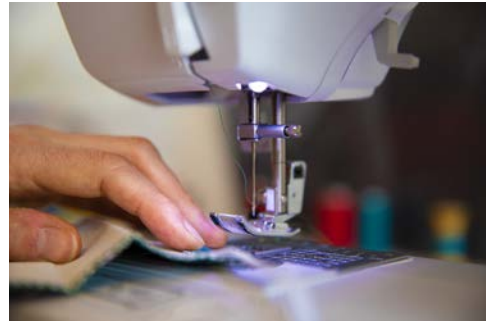
Мал. 17.6. Під час шиття потрібно стежити, щоб палець не потрапив під голку.
