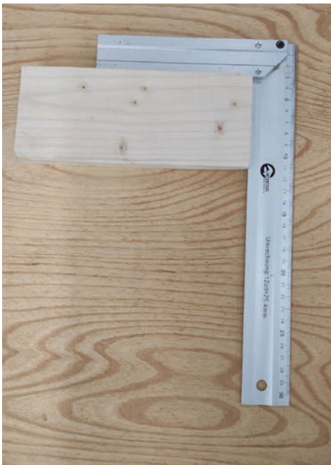
Мал. 18.9. Контроль показників за допомогою столярного кутника
