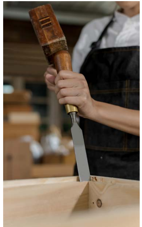
Мал. 18.10. Процес заглиблення долота
